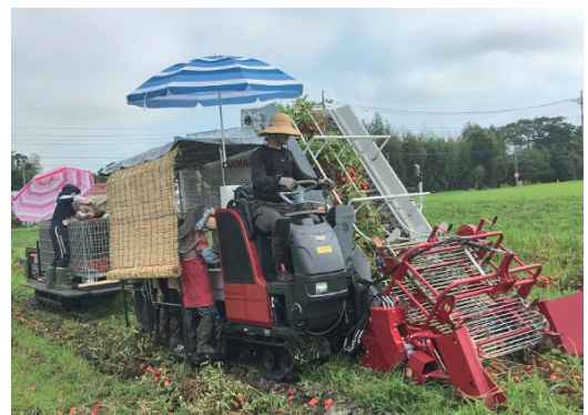
ジュース用トマトの機械収穫
